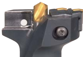
1. Pilotbohrer im Grundkörper einsetzen, Höhendifferenz zwischen Pilotbohrerspitze und Wendeplatten nach Tabelle auf Seite E59 einstellen und befestigen.
